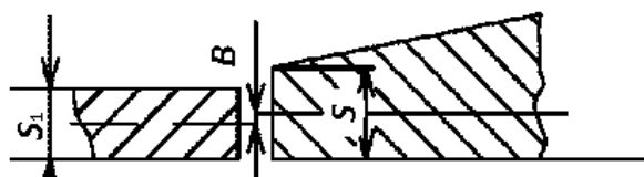
Рисунок 12.2. Смещение кромок листов в стыковых продольных соединениях
