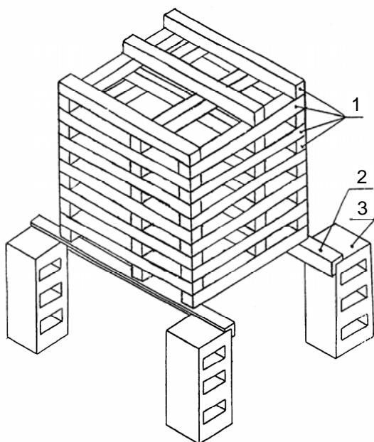
A.2.1.1.3 Бруски, образующие наружные грани штабеля, могут скрепляться для прочности скобами или гвоздями. Штабель выкладывается так, чтобы бруски каждого последующего слоя были перпендикулярны брускам ниже лежащего слоя. В каждом слое должно быть по 3 бруска. Количество слоев — 12. При этом по всему объему должны образовываться каналы прямоугольного сечения.
